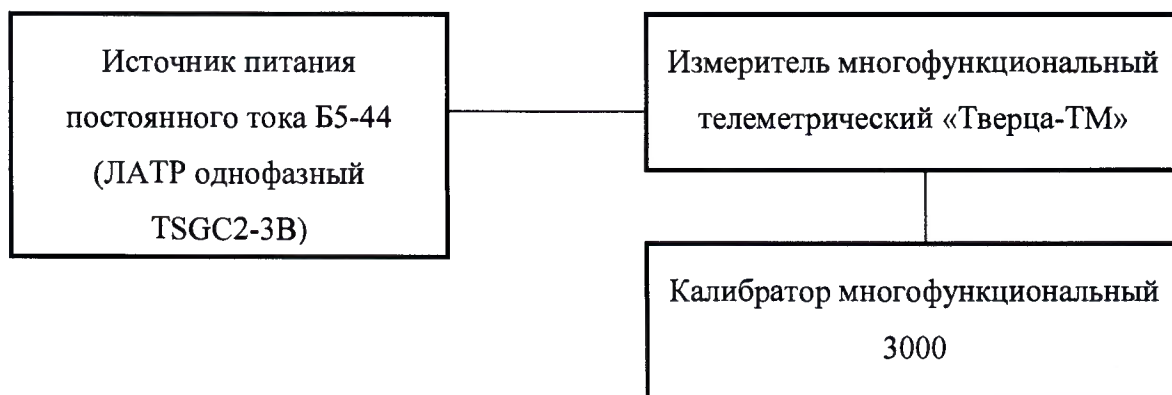
Рисунок 1 – Схема определения основной абсолютной погрешности измерений силы и напряжения постоянного тока
